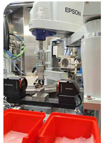
Avtomatska kontrolo končnih izdelkov.
