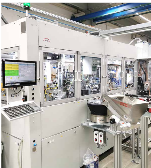
Del linije za sestavo novega inštalacijskega odklopnika ETIMAT
