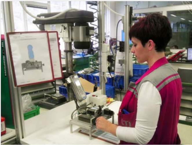
Vzorčno merjenje kontaktne sile na KZS
