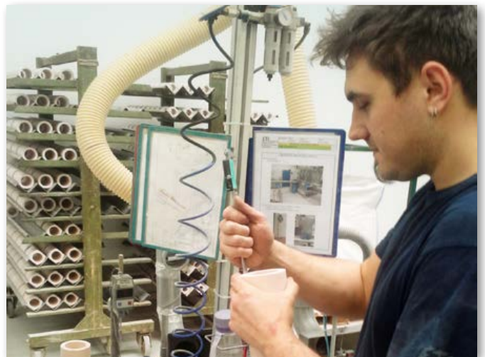
Vzorčno merjenje globine navojev na vl. NV
