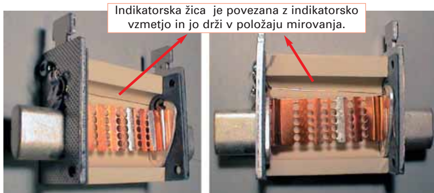
Slika 6: Bližnje slike standardnega indikatorja v prerezu
